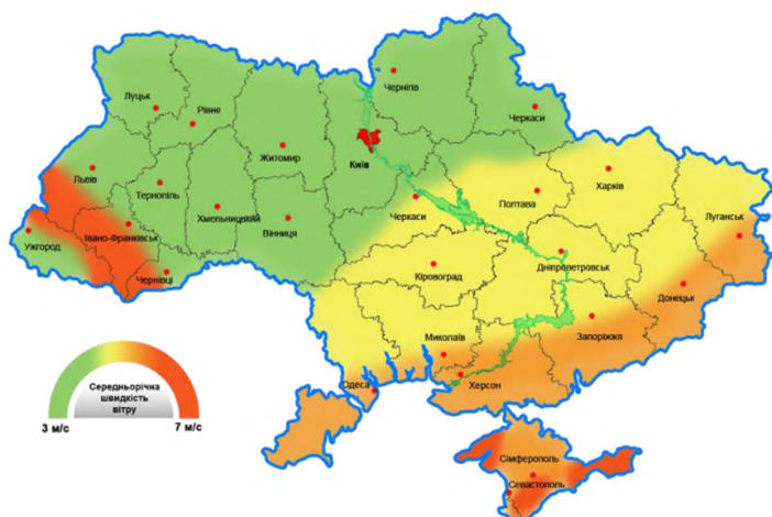
Рис. 1.6. Карта середньої швидкості вітру в Україні 4,1 м/с, що є високим показником для використання вітроенергетики.
